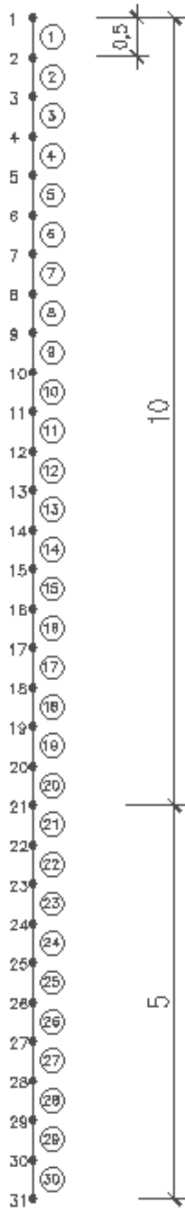
Figur 4.2: Numrering av element och noder
