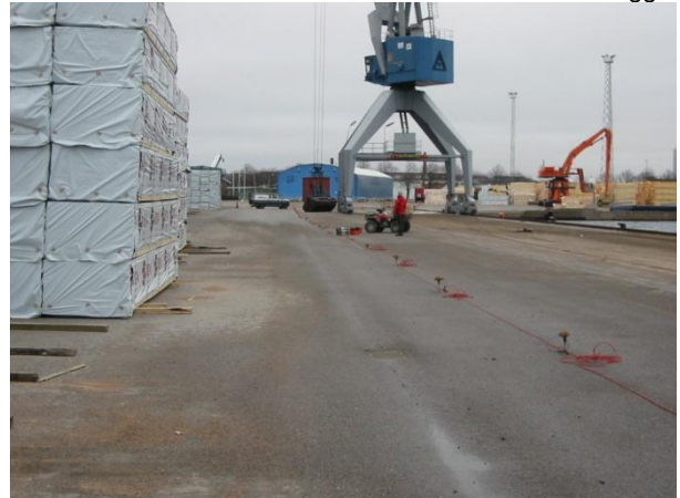
Figur 3. Mättlugg med geofoner och geofonkabe på asfaltva.
