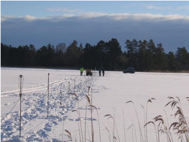
Figur 4. Mätning på vintern med mätutlägg med geofoner och geofonkabe på is.
